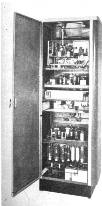
Bild 1. Innenansicht des ersten UKW-Versuchssenders des Bayerischen Rundfunks, der von der Fa. Rohde & Schwarz gefertigt wurde (oben: Endstufe, darunter Oszillator- und Verdopplerstufen, unten Netzteil)
